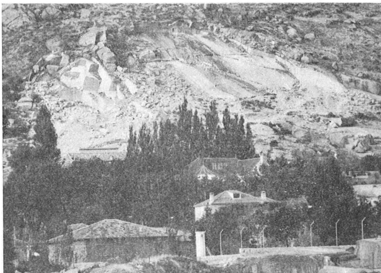
Fig. 1.—Frentes de corta en la ladera del cerro de La Machota (Zarzalejo). Se observa el aprovechamiento que se hace de los sistemas de diaclasas
